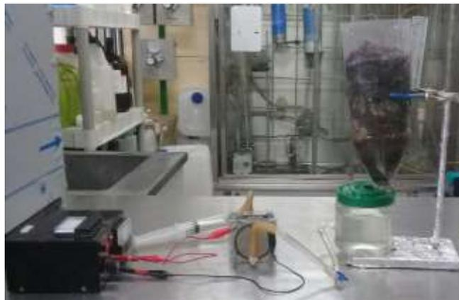
*Figura 19. Prototipo de sistema para la obtención de Hidrógeno-Oxígeno.*
