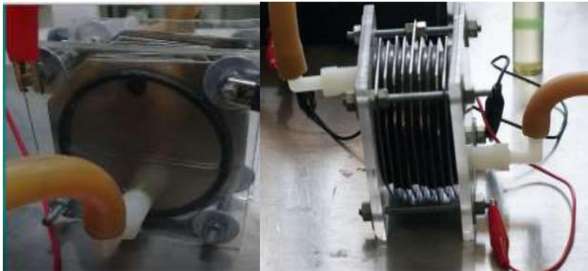
*Figura 17. Prototipo de celda electrolítica usado en este trabajo.*
