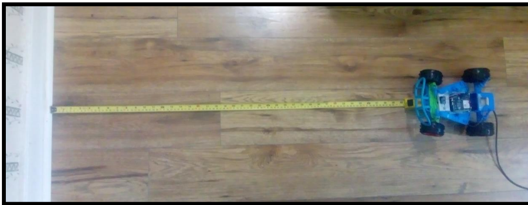
Figura 62. Vista preliminar de la prueba de impacto frontal con el prototipo montado en un auto a escala.
