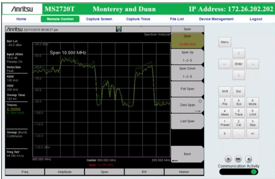
Figura 73. Señal utilizando la opción Remote Control mediante conexión por Ethernet [59].
