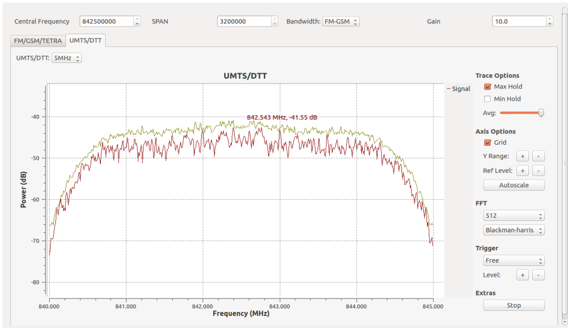
Figura 59. Señal en alto de UMTS para una frecuencia central de 842.5 MHz con el analizador "SpA-SDR".
