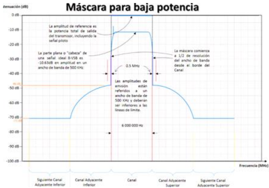
Figura 2. Máscara de emisión para Estaciones de Televisión y Equipos Complementarios de Baja Potencia
