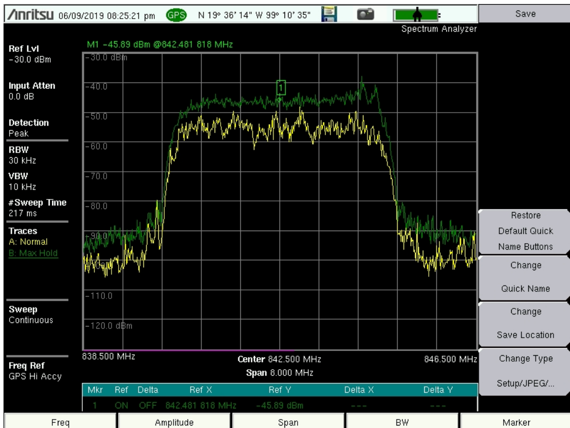
Figura 58. Señal en alto de UMTS para una frecuencia central de 842.5 MHz con el analizador Anritsu.
