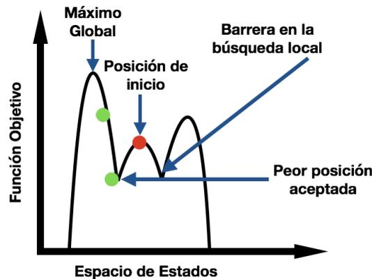
Figura 2.36: Algoritmo de búsqueda heurística Simulated Annealing
