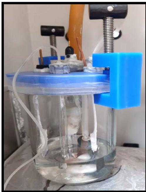
*Figura 2-7 Reactor Fotoelectrocatalítico para degradación de contaminantes.*
