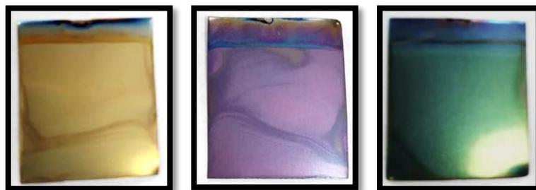
*Figura 3-1 Coloración superficial de los electrodos de TiO<sub>2</sub> dopados con C y N al finalizar su síntesis por anodizado; de izquierda a derecha, anodizados a 50V, 70 V y 90V*
