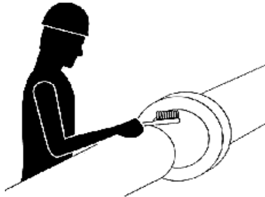
Fig. 12.- Limpieza de campana.
