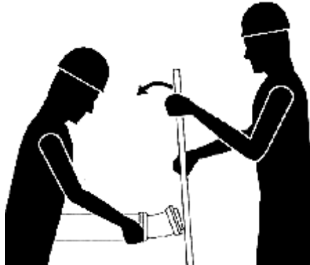
Fig. 19.- Montaje de piezas especiales con junta automática.
