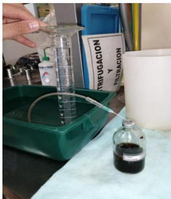
**Figura 5.** Cuantificación del volumen de biogás generado por desplazamiento de columna.
