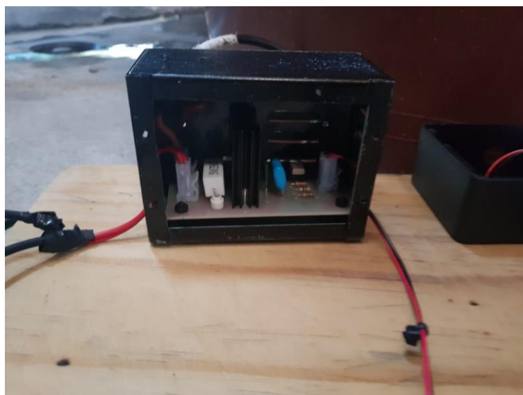
Figura 61 Montaje de placa electrónica Circuito Triac/MOC
