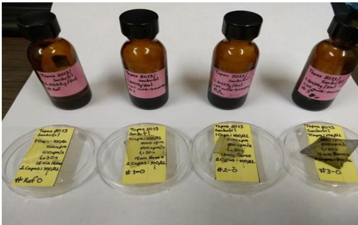
Figura IV. 1. Película delgada fabricada de la solución de COC-TOPAS 5013 con concentración de MW-CNT indicada en la Tabla IV.1.
