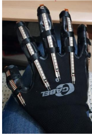
Figura 35. Sensores de Flexión ajustados al guante industrial. Elaboración propia.
