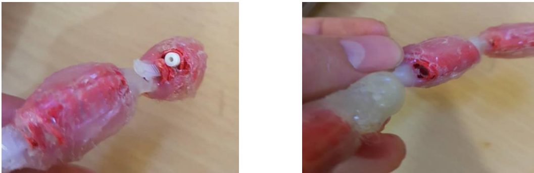
Figura 41. Orificios para tendones dentro del dedo. Elaboración propia.
