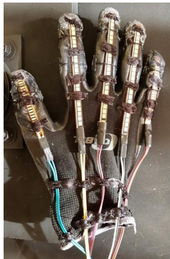
Figura 36. Construcción final de guante con sensores de flexión adheridos. Elaboración propia.
