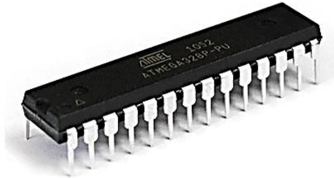
Figura 41 - Microcontrolador ATmega328P en encapsulado THT [31].
