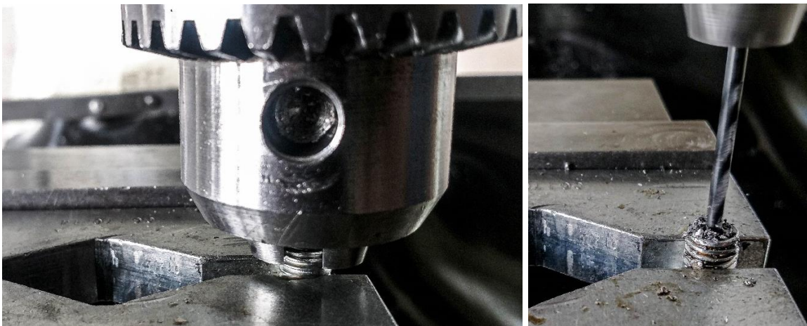
Figura 65 - Adaptación de Rotulas M8 a perforación M3
