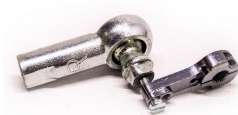
Figura 49 - Ensamble de rotula inferior con cuerno del servomotor
