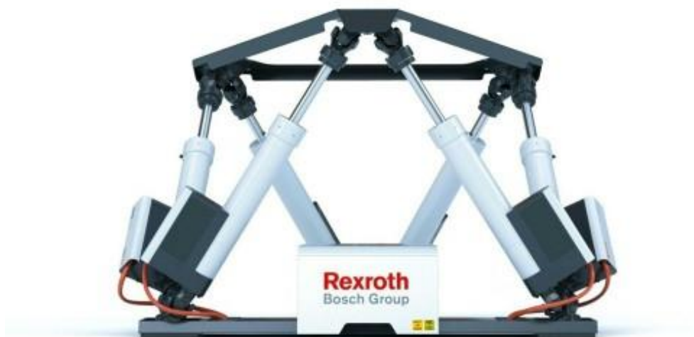
Figura 10 - Robot paralelo de 3-DOF desarrollado por Rexroth [14].
