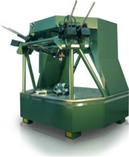
Figura 11 - Máquina de medición de coordenadas (MMC) desarrollada por Lopic [15].
