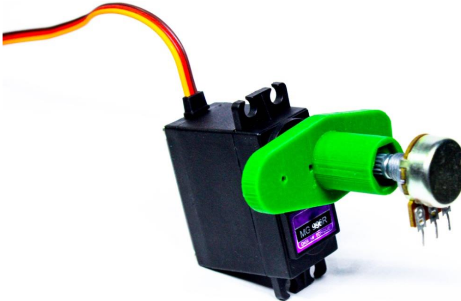
Figura 82 Potenciómetro acoplado a servomotor por pieza de impresión 3D.
