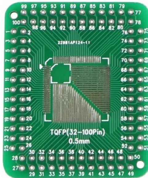
Figura 67 - Adaptador SMD a THT para empaquetado TQFP100
