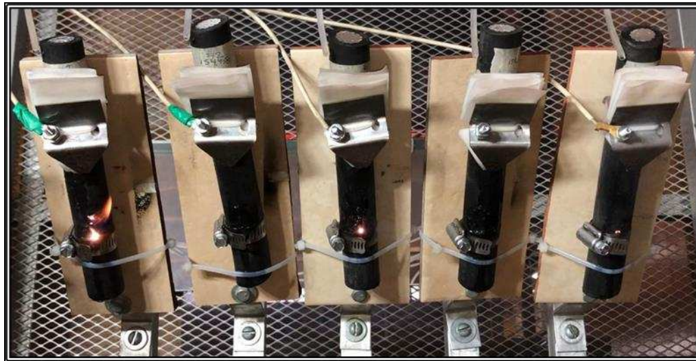
Figura 2.8. Prueba de plano inclinado en muestras de cables [13].
