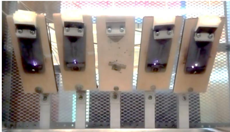
Figura 2.6. Prueba de plano inclinado en muestras planas [13].
