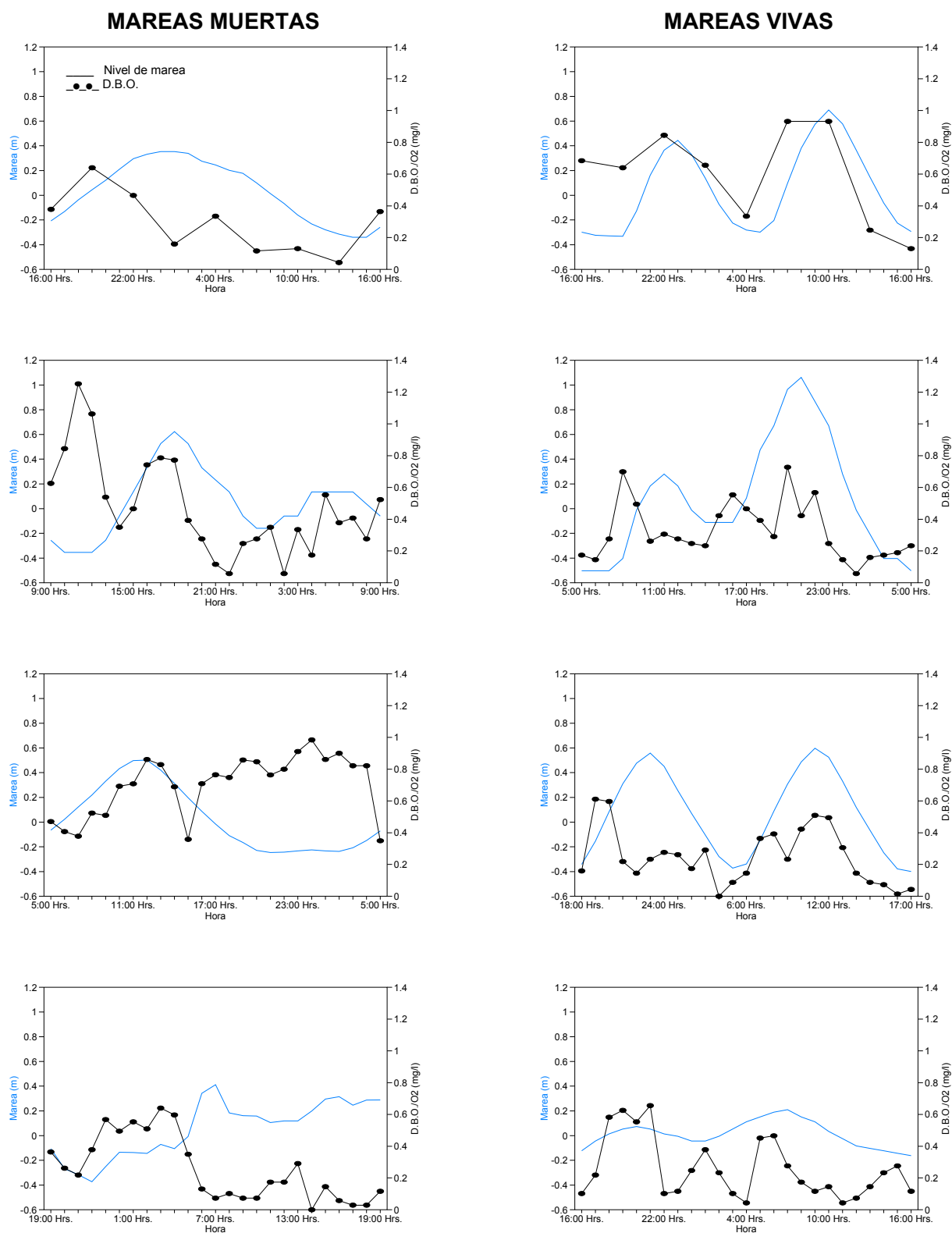
Fig. 11 Variación de la demanda bioquímica de oxígeno del agua durante el año 2002 en el manglar El Conchalito, para los cuatro muestreos del año (febrero en la primer fila, junio en la segunda, septiembre en la tercera y noviembre en la cuarta fila).
