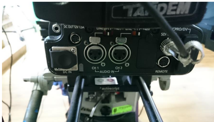
Figura 3.17. Cable coaxial que va a la hacia la salida interfaz serial digital (SDI)
