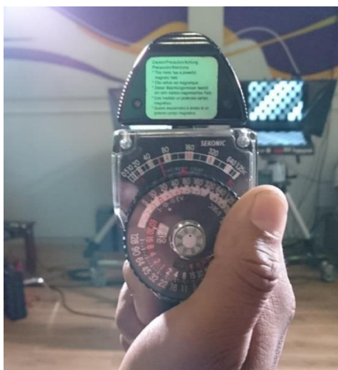
Figura 3.12. Medción con el fotómetro la cual indica un diafragma de 4.0 o F4
