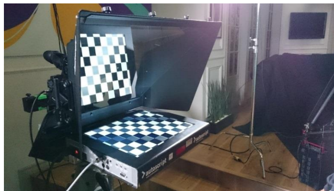
Figura 3.20 Apuntador óptico (teleprónter) marca auto autoscript.
