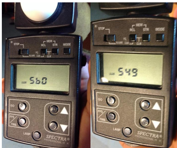
Figura 3.11. a) Se muestra la cantidad de luminosidad de la luz secundaria (Fill light) 560 luxes (Lx), Se muestra la cantidad de luminosidad de la luz escenografía (Back ground) 549 luxes (Lx).
