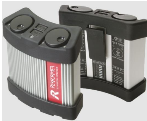
Figura 3.44. Beltpack C3 lo utilizan los camarógrafos para recibir indicaciones del director de cámaras, Beltpack tiene tres conectores XLR, uno para auriculares, uno para entrada de la señal y otro para el paso de señal
