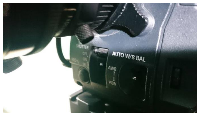
Figura 3.15. Interruptor que ayudara a realizar el balance de blancos (White balance) haciendo el ajuste en el centro de lo que va a iluminar
