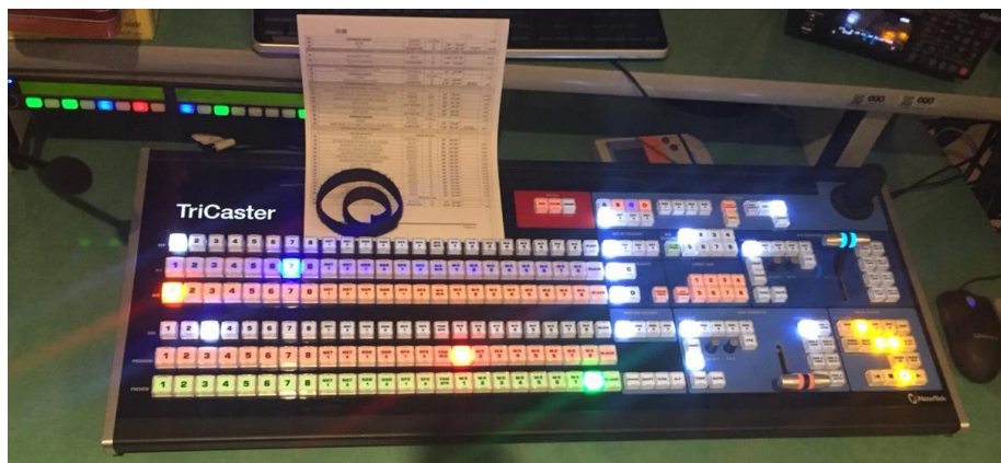
Figura 3.22. Switcher ocupado en los programas del canal 14.1
