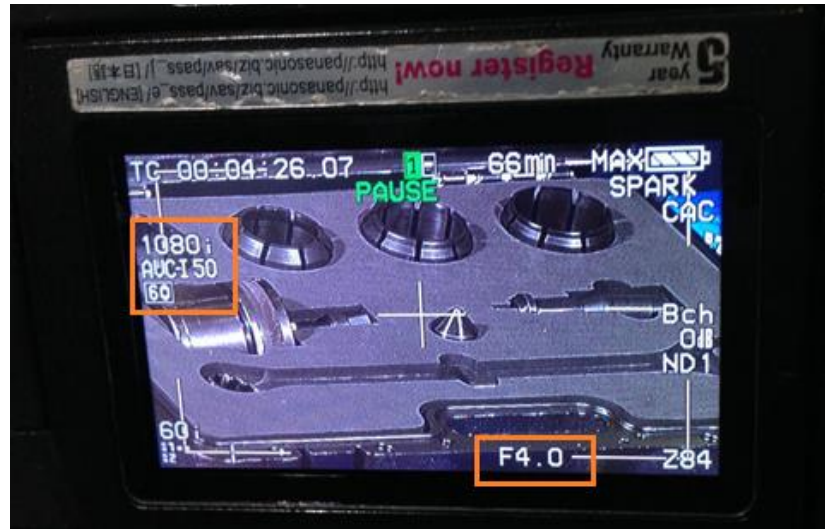
Figura 3.16. En la cámara se muestra cómo se trabajará un diafragma de F4.0 y con una definición HDTV de 1080 i
