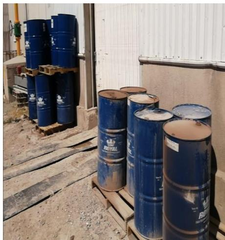
**Figura 22.** Almacenamiento inadecuado de RP
