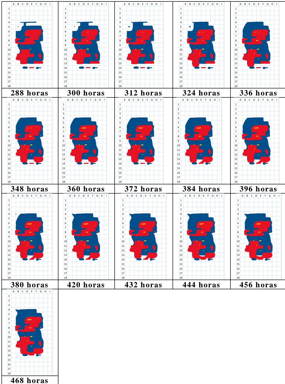
Figura 25. Resultados del mapeo de la tercera prueba de cargado catódico en el acero AIC2.
