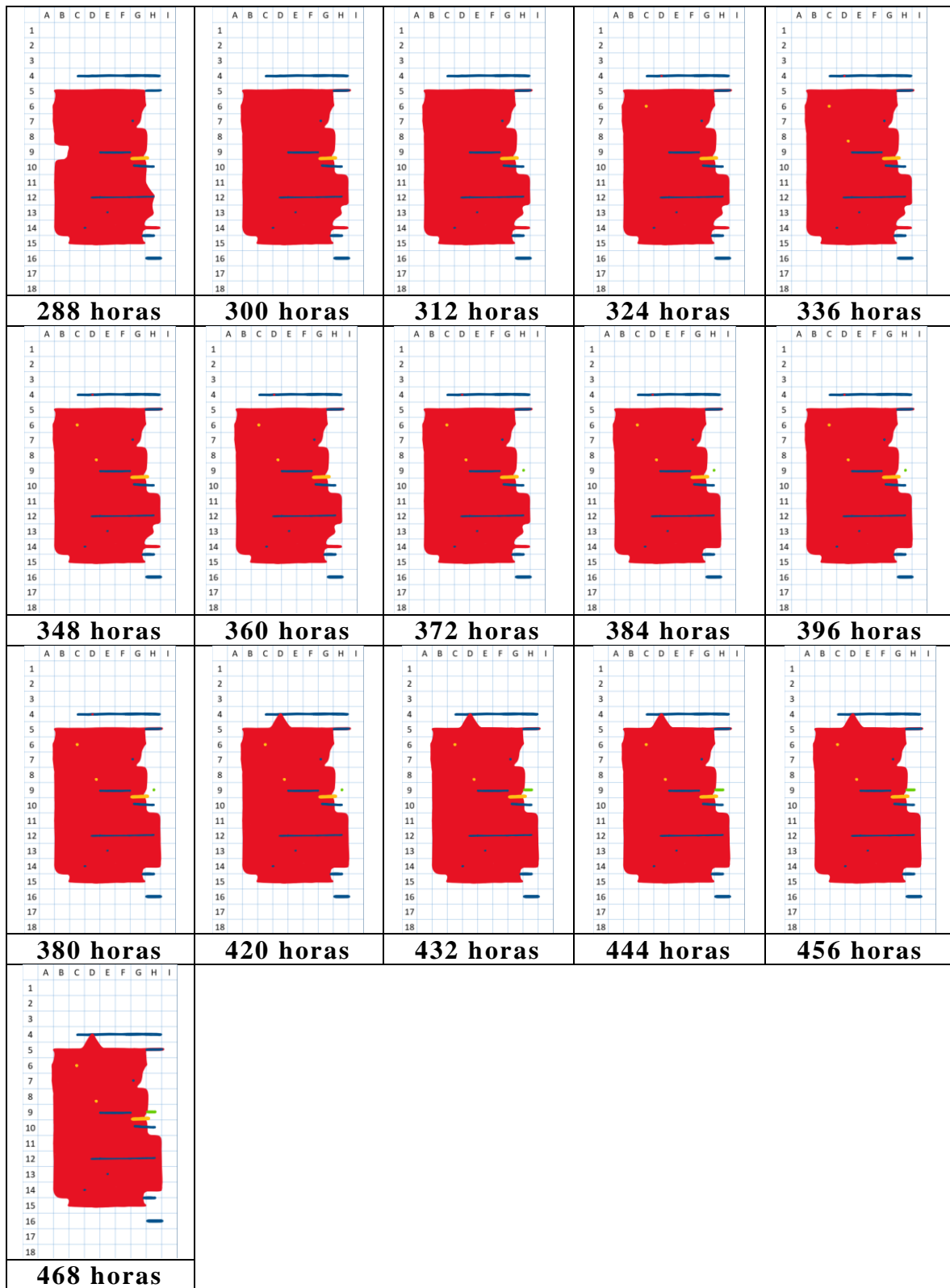
Figura 24. Resultados del mapeo de la segunda prueba de cargado catódico en el acero AIC2.
