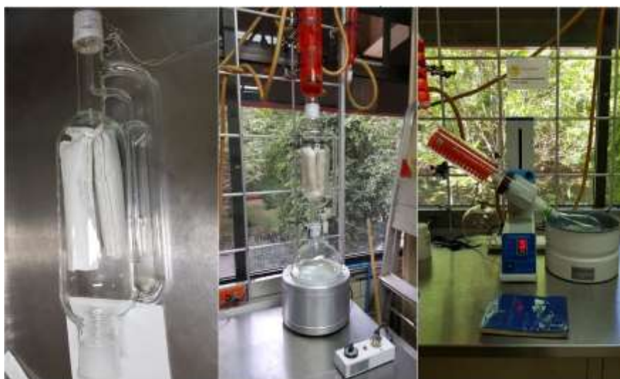
Figura 3. Montaje de sistema soxhlet y rotavapor hahnvapor
