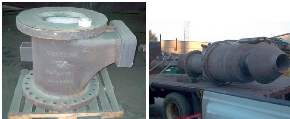
Figura 31. Ejemplos típicos de una válvula deslizante y válvula tapón [10].
