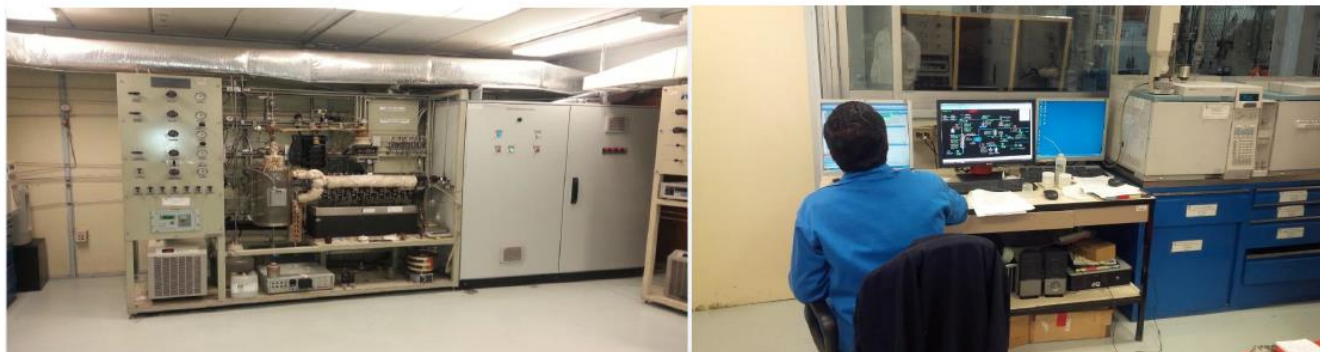
Figura 19. Unidad ACE-R para evaluar catalizadores [9].
