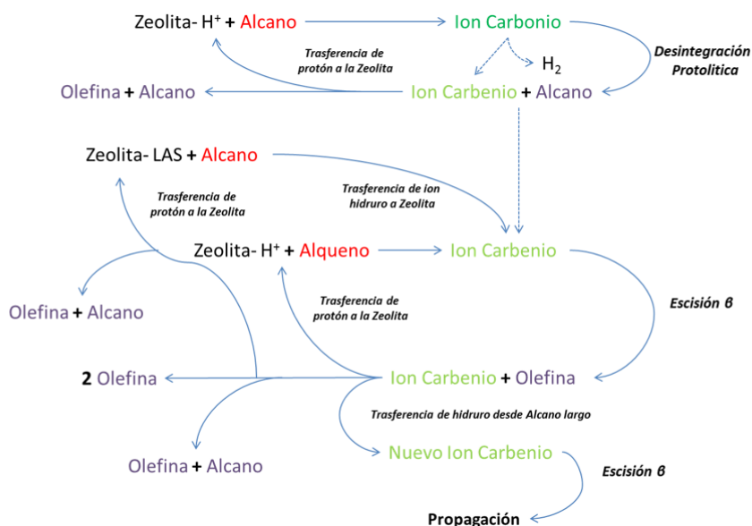
Figura 18. Red de reacción en desintegración de moléculas de hidrocarburos asistidas con zeolita [3].
