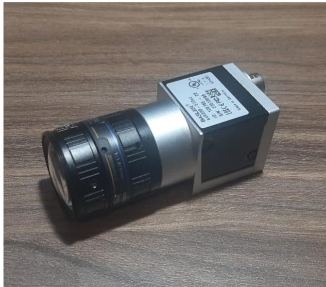
Figura 3.1.2: Cámara Basler acA800 con lente Basler C125 0418
