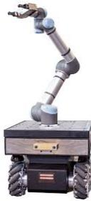
Figura 1.3.1: Manipulador móvil omnidireccional comercial. [31]
