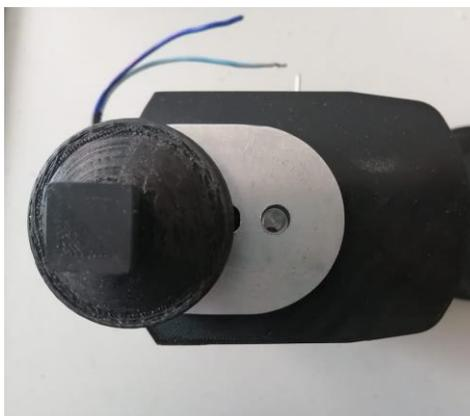
*Figura 91. Perforación de tornillo sinfín y tapa de estructura para encoder.*
