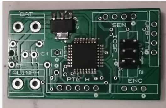
Figura 94. PCB con componentes superficiales.
