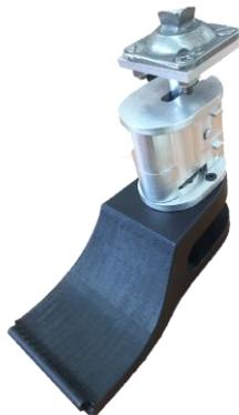
*Figura 17. Estructura de la prótesis sin componentes electrónicos.*
