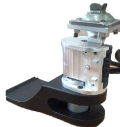
*Figura 18. Estructura de la prótesis sin componentes electrónicos, vista lateral.*
