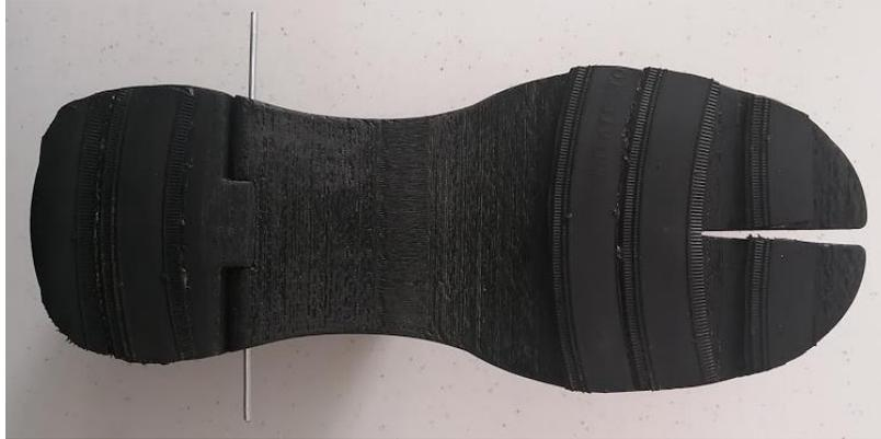
Figura 92. Suela de prótesis con Nylon.
