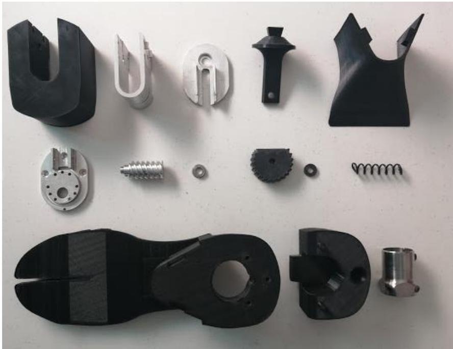
*Figura 89. Elementos mecánicos de la prótesis.*
