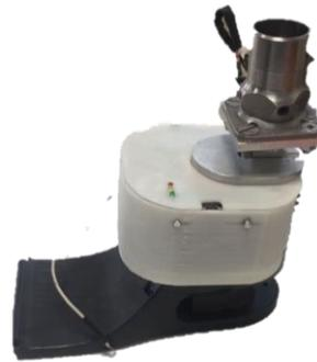
*Figura 16. Vista lateral de prótesis biónica, se muestra en blanco el contenedor con la electrónica del sistema.*
