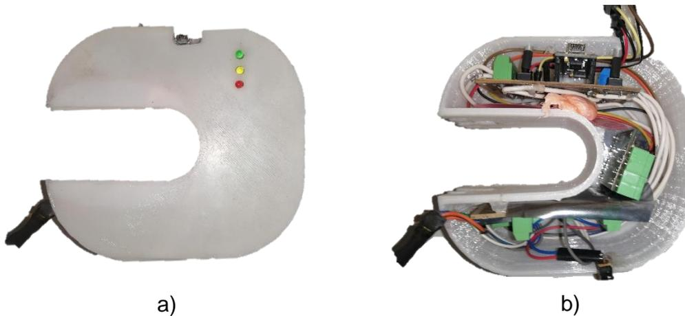
*Figura 24. Componentes electrónicos de la prótesis, en a) se muestra el espacio de la electrónica cubierto. En b) se muestra el espacio de electrónica descubierto, se pueden observar los componentes y espacios que lo conforman.*
