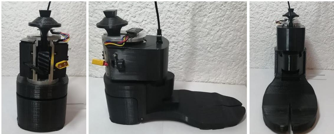
*Figura 103. Vista trasera, lateral y frontal de prótesis.*
