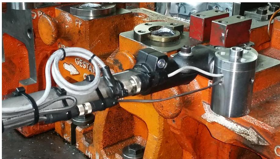
**Figura 3.5. Ejemplo de sujeción con electroimán [15].**
