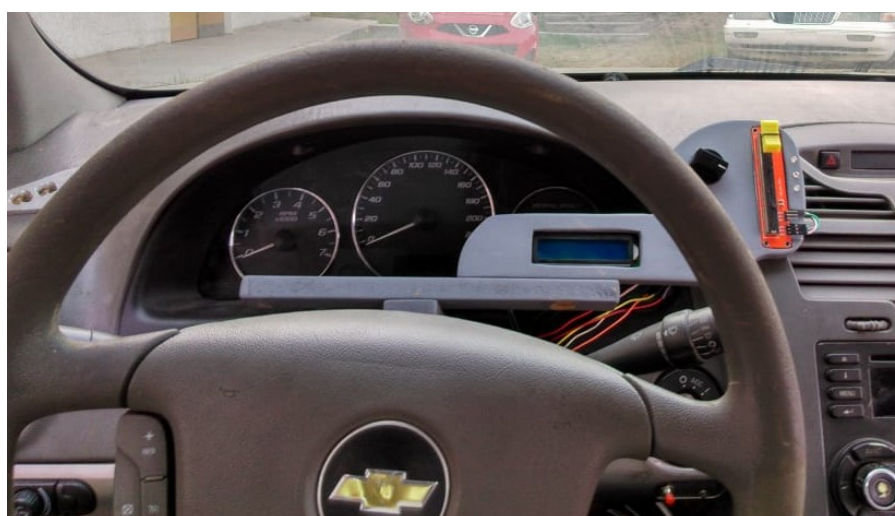
Figura 41: Sistemas de freno y aceleración adaptados atrás del volante.
