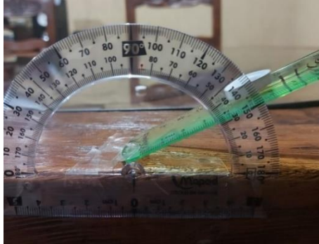
Imagen 39. Tableta a un ángulo de 30° donde se desliza.
