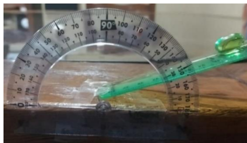
Imagen 41. Cápsula a un ángulo de 25° donde no se desliza.
