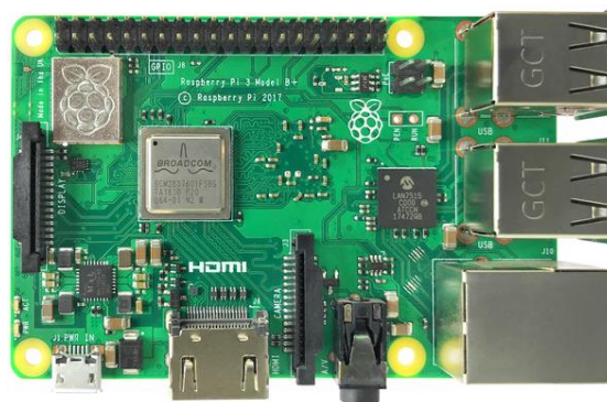
Imagen 152. Tarjeta de procesamiento de datos Raspberry Pi 3 b+. [51]
