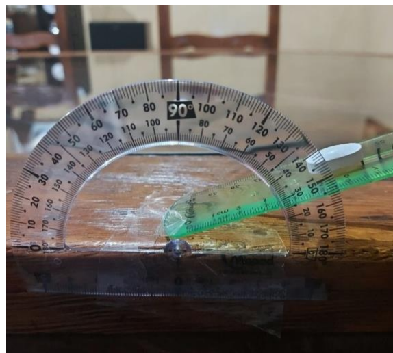
Imagen 38. Tableta a un ángulo de 25^\circ donde no se desliza.
