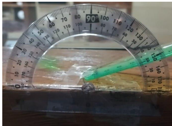
Imagen 43. Cápsula a un ángulo de 30^\circ donde ya se deslizó.
