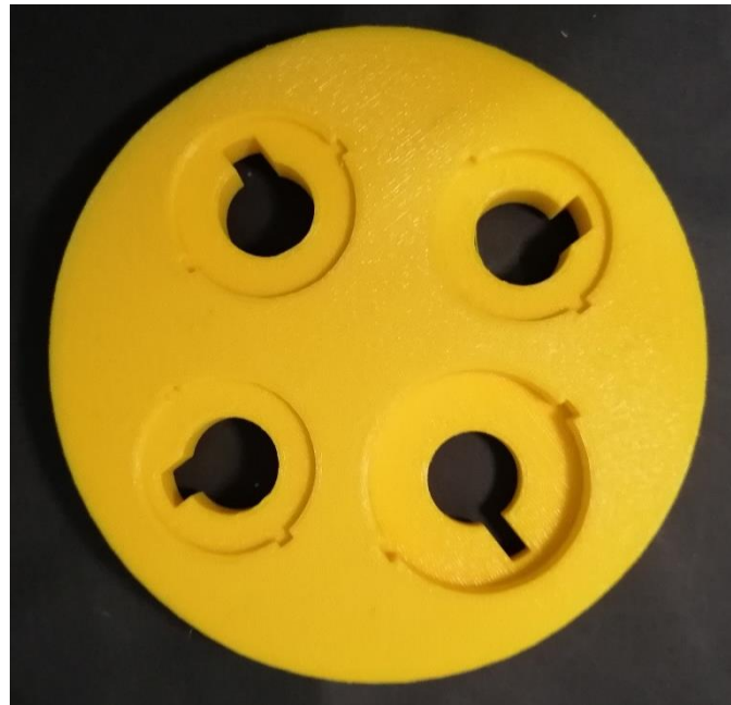
Imagen 194. Vista superior del revolver, se logra apreciar los espacios de ensamble.
