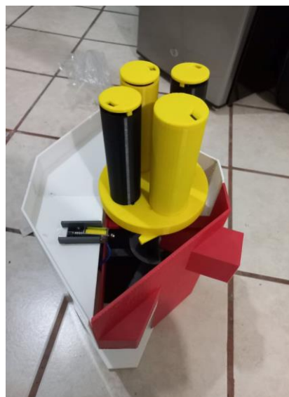
Imagen 232. Ensamblaje de los contenedores con el revólver.
