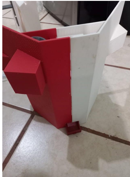
Imagen 237. Ensamble de la caja para desecante con la carcasa inferior.
