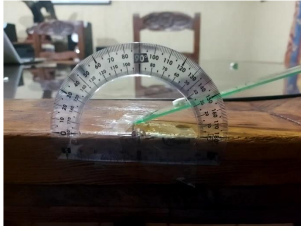
Imagen 37. Comprimido a un ángulo de 28.5^\circ donde se empieza a deslizar.
