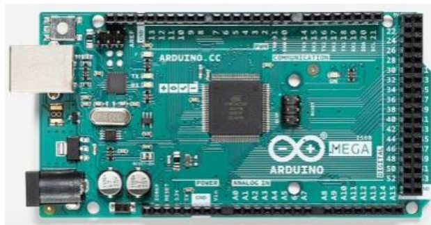
Imagen 154. Tarjeta de procesamiento de datos Arduino Mega 2560. [53]
