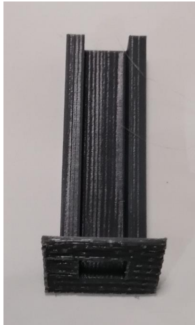
Imagen 205. Rampa de entrada de las pastillas.
