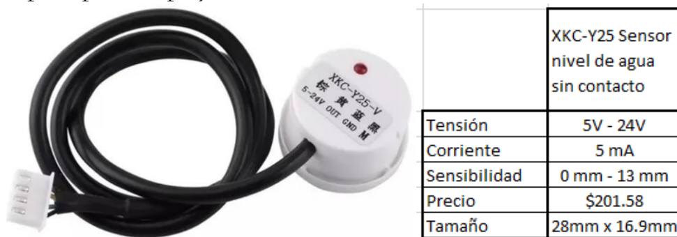
Imagen 59. Sensor XKC-Y25-V con sus respectivas especificaciones.
