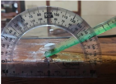
Imagen 40. Tableta a un ángulo de 30° donde ya se deslizó.
