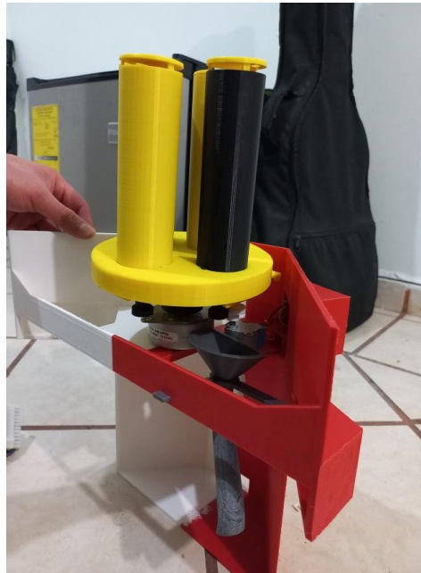
Imagen 236. Ensamble del motor a pasos unipolar con los transmisores de movimiento de los tornillos sin fin.
