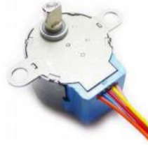
Imagen 74. motor 28BYJ-48. 5 VCD, 40 mA/fase, tamaño: 35 mm, cuenta con driver, torque: 0.02942 Nm [38].
