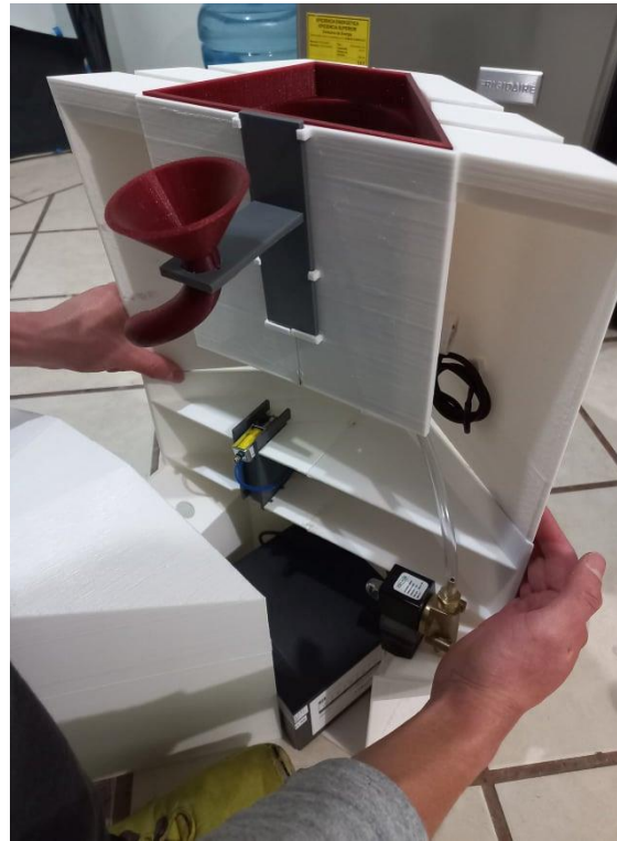
Imagen 235. Ensamble del embudo de entrada de pastillas junto con su soporte.
