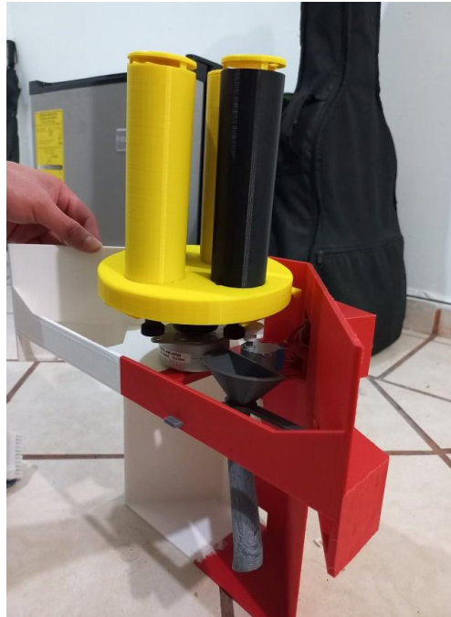
Imagen 233. Ensamble del revolver con los contenedores al motor a pasos bipolar.
