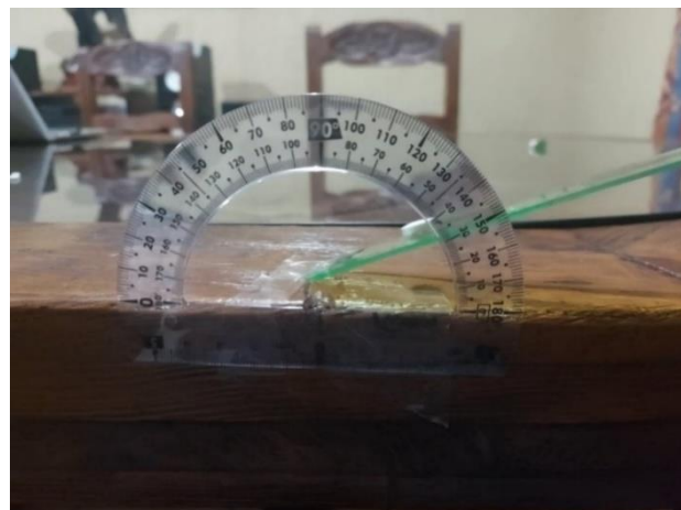
Imagen 36. Comprimido a un ángulo de 30^\circ donde se desliza.
