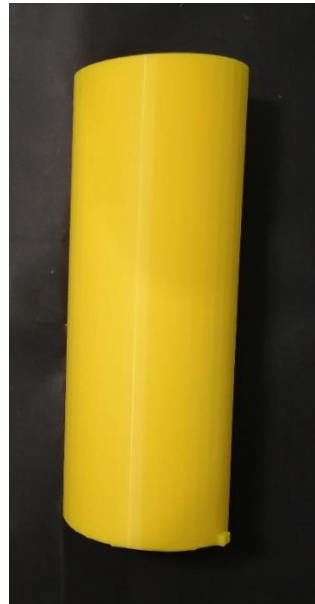
Imagen 195. Vista lateral de uno de los compartimentos, en la parte inferior se aprecian las ranuras de anclaje al revolver.
