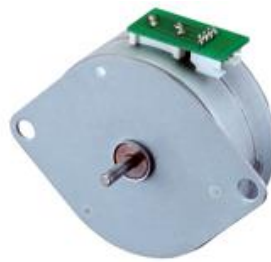
Imagen 75. motor PM55L-048. 24 VCD, 600 mA/fase, tamaño: 65 mm, cuenta con driver, torque: 0.11376 Nm [39].
