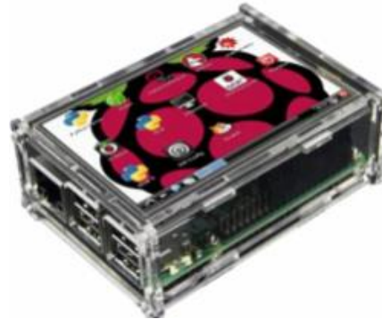
Imagen 166. Pantalla de 3.5' con conexión HDMI-SPI Raspberry [58].
