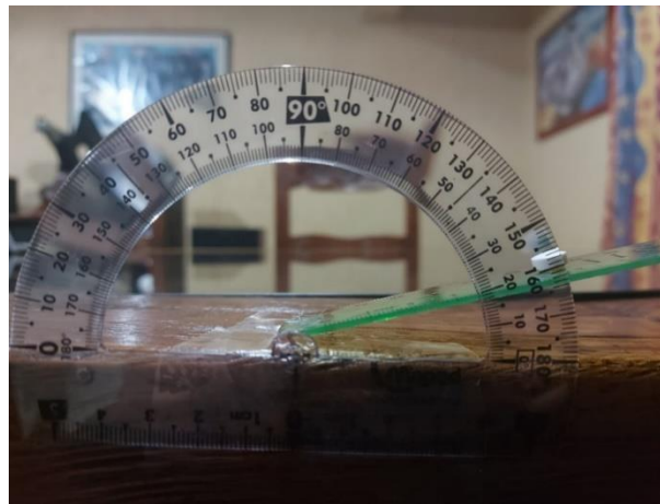
Imagen 35. Comprimido a un ángulo de 18^\circ donde no se desliza.
