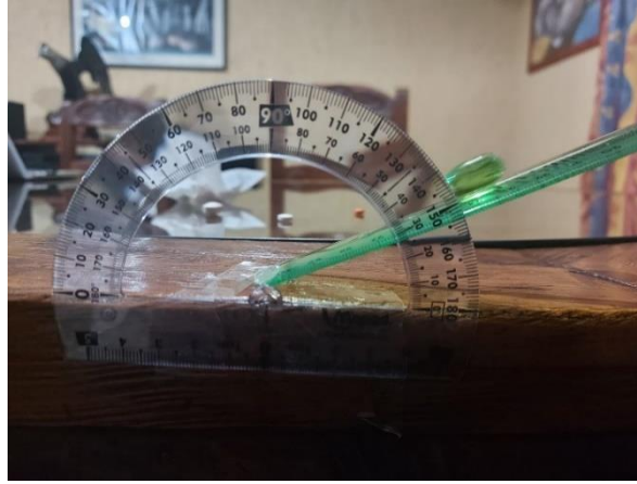
Imagen 42. Cápsula a un ángulo de 30^\circ donde se desliza.
