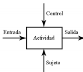
Figura 1.13 Representación a bloque de una actividad para un modelo IDEF0
