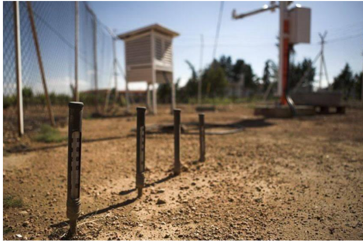
Figura 1.4 Termómetro que sirve para medir la temperatura del suelo a profundidades de 5, 10, 20, 50 y 100 cm por debajo de la superficie [12].
