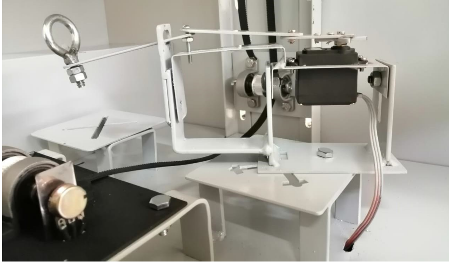
Figura 77: Montaje del mecanismo del dedo pulgar en la estructura.
