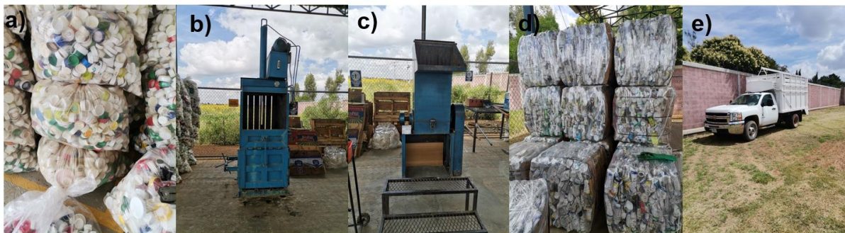
Figura 6. Técnicas de acondicionamiento de los envases vacíos de agroquímicos, a) acondicionamiento y/o clasificación, b) compactación, c) trituración d) resultado de la compactación e) transporte a disposición final (Fuente: Elaboración propia).
