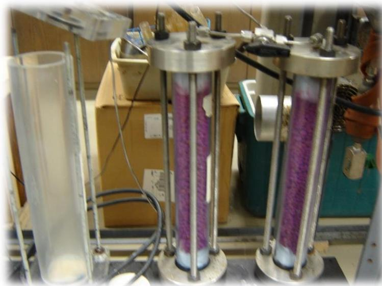
**Fig. 26** Eliminador de H<sub>2</sub>S y columna de Drierita.
