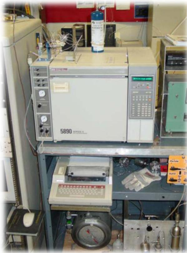
**Fig. 27** Cromatógrafo de gases HP 5890 Series II.
