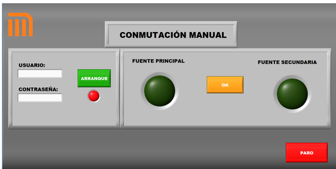
Fig. 3.3-32 Ventana principal de conmutación manual.
