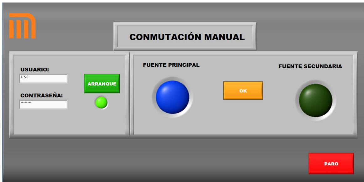
Fig. 3.3-36 Ventana de acceso a la conmutación manual.
