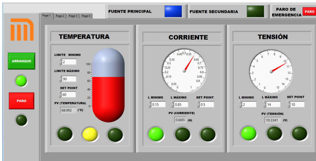
Fig. 4.1-16 Variable de Temperatura cerca del límite establecido en la HMI.
