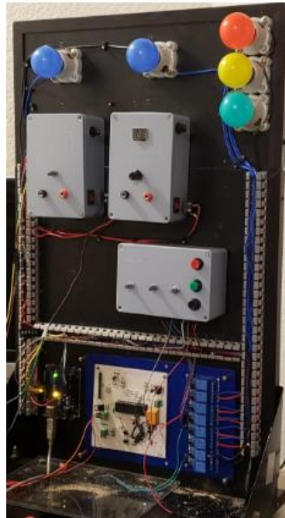
Fig. 4.1-3 Prueba de energización del microcontrolador.
