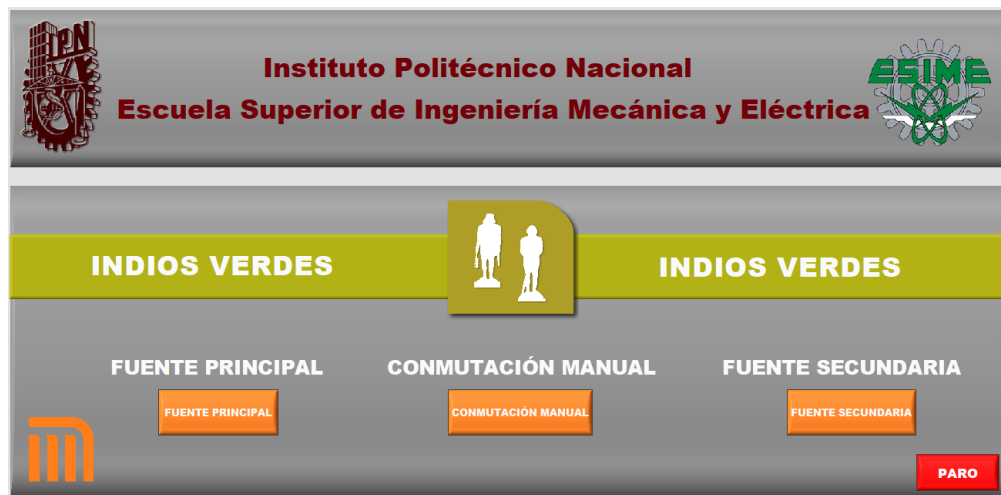
Fig. 4.1-9 Prueba 2 del sistema de conmutación automática y la HMI.
