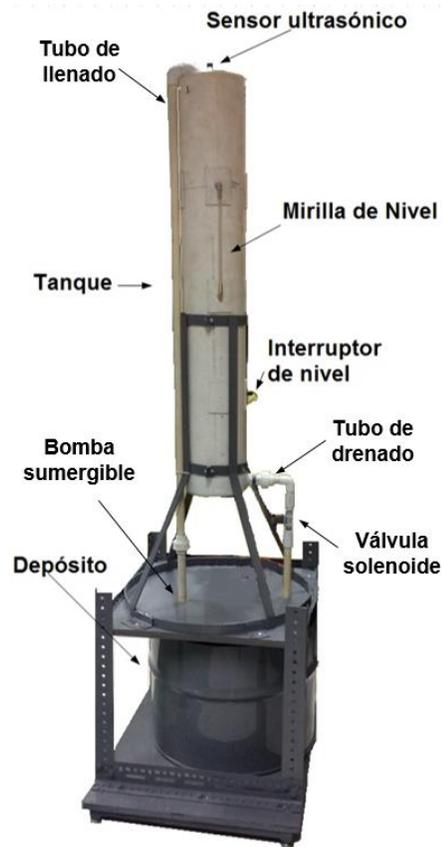
Figura 2.1 Estructura básica del módulo didáctico de medición de nivel.
