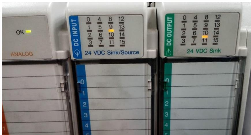
Figura 4.4 Slots con leds indicadores.
