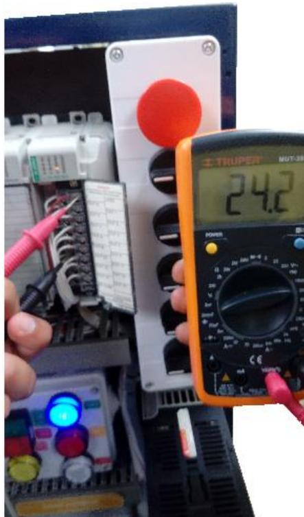
*Figura 4.3 Pruebas de alimentación de tensión eléctrica.*
