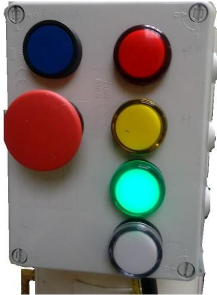
*Figura 4.9 Botonera de alarmas del módulo de nivel.*
