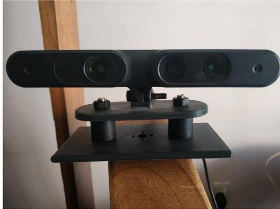
Figura 76: Montaje de la cámara para colocarla en el efector final.
