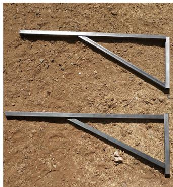
Figura 67: Construcción de las ménsulas que sirven de soporte al Cartesiano.
