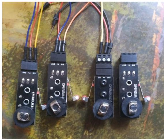
Figura 78: Módulos de interruptores de final de carrera acondicionados.
