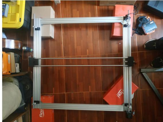
Figura 74: Construcción del Cartesiano sin el efector final.
