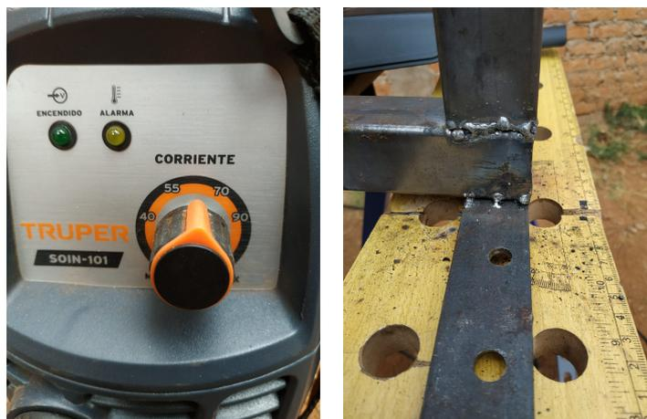
Figura 69: Configuración de la máquina y técnica de soldadura empleada.
