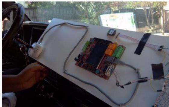
Figura 7: Sistema embebido en tiempo real incorporado al interior del vehículo para monitoreo de su trayectoria.
