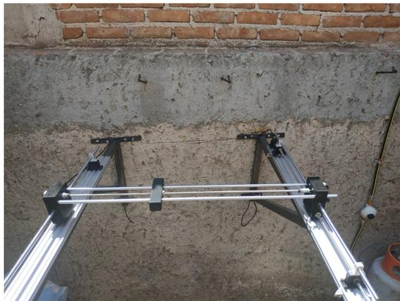
Figura 77: Sistema Cartesiano montado en las ménsulas.
