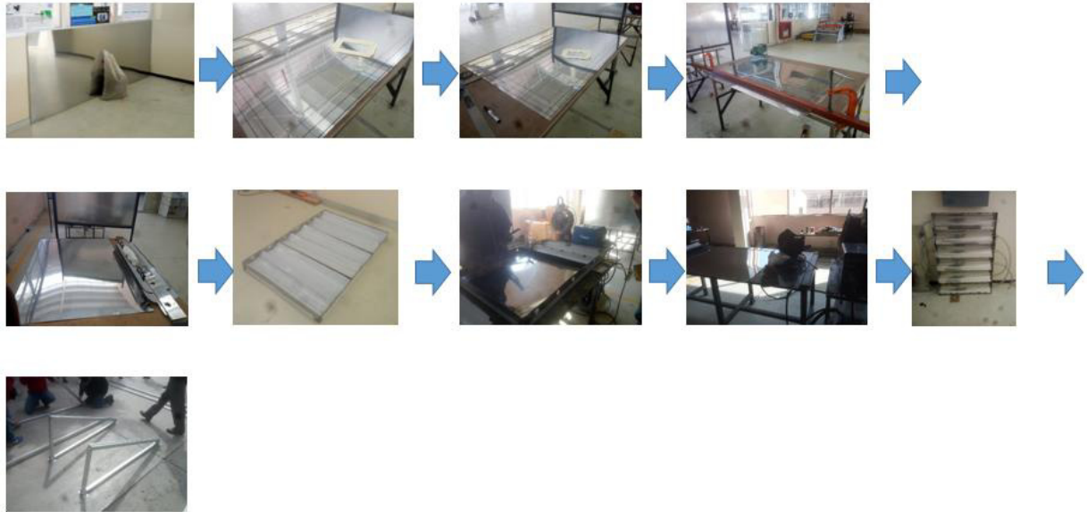
Figura 14. Corte de la lámina de acero 430 calibre 22 para la construcción del marco y la superficie reflectora.
