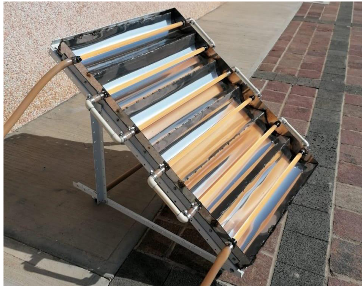
Figura 15. Reactor CCP, arreglo de 6 parábolas.
