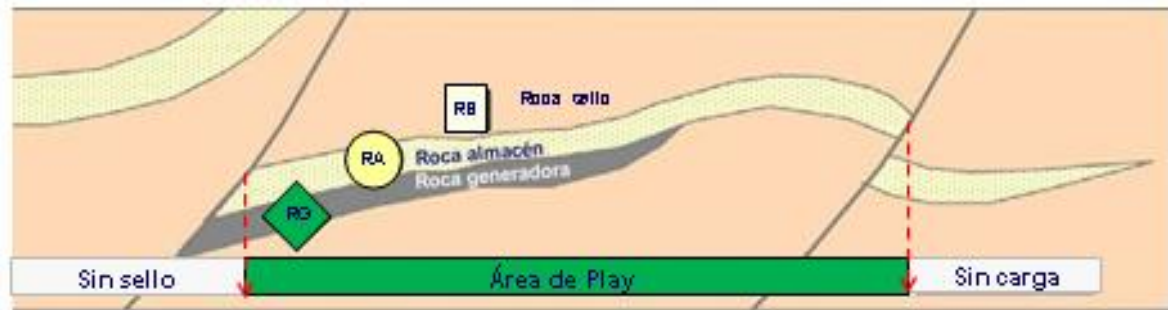
Figura 3.3.1. Diagrama de la extensión de un Play con base en la presencia de los elementos que los constituyen (OETR, 2011).
