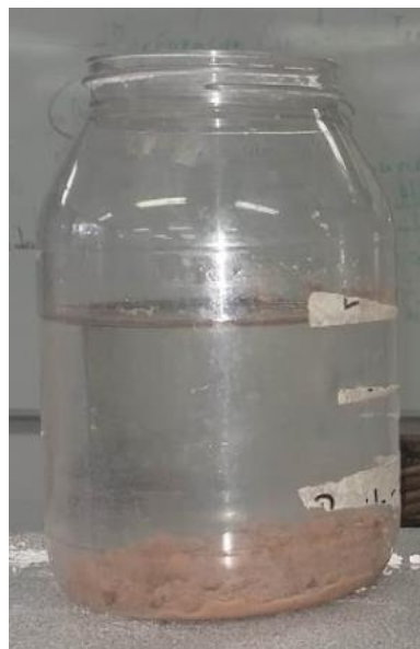
Figura 24. Separación de fases en un sistema con Bentonita de mala calidad.
