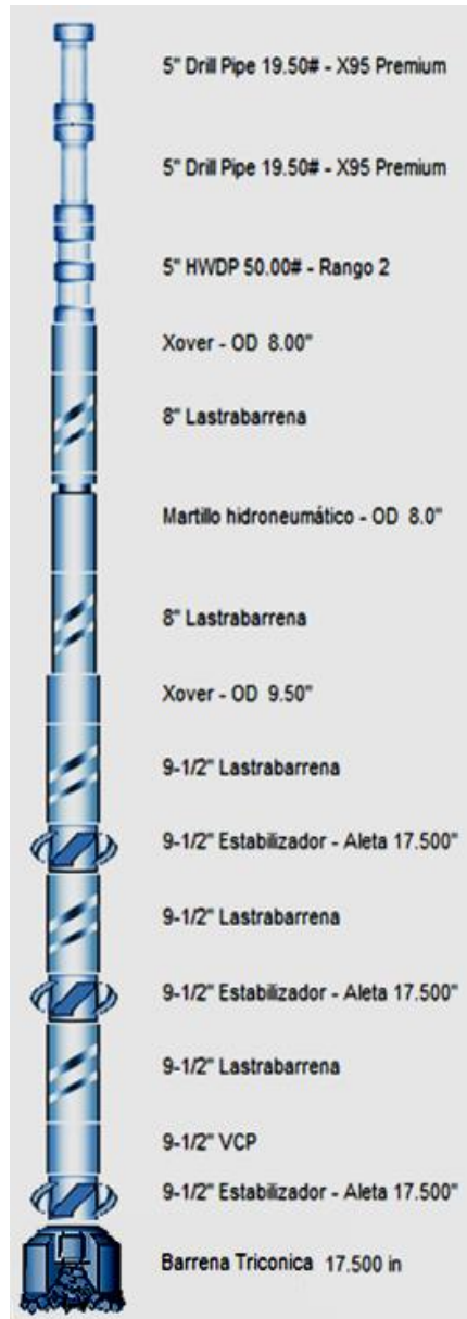
Figura 20.- Segunda etapa de 17½ pulgadas del pozo BTPKS 4.
