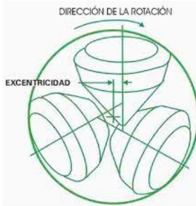
Figura 14.-Mecanismo de corte de barrenas de conos de rodillos.
