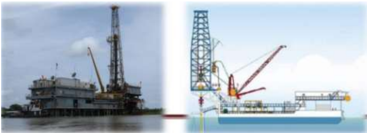
Figura 31. Barcaza de perforación.
