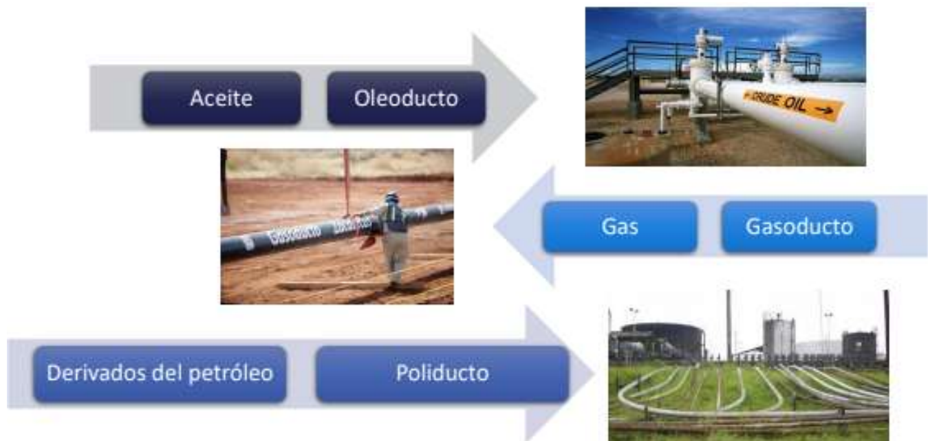
Figura 27. Clasificación de ductos.
