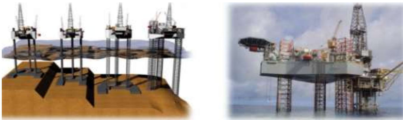
Figura 33. Plataforma auto elevable de perforación.
