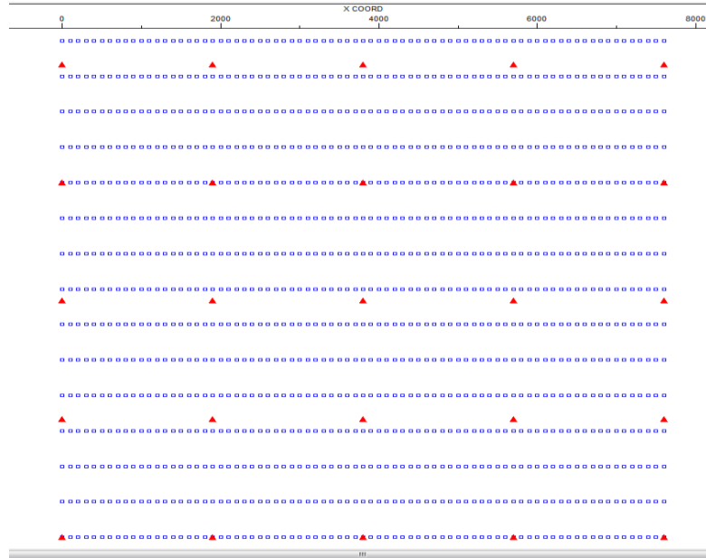
Figura 28. Esquema de adquisición “Tendido Fuente-Receptor” (Fuentes color rojo y receptores color azul).
