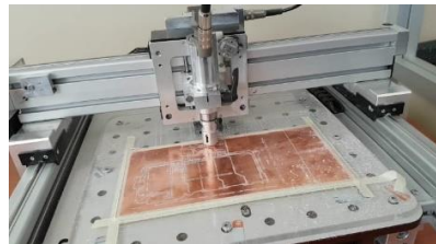
Figura 46. Impresión de circuito de interfaz.
