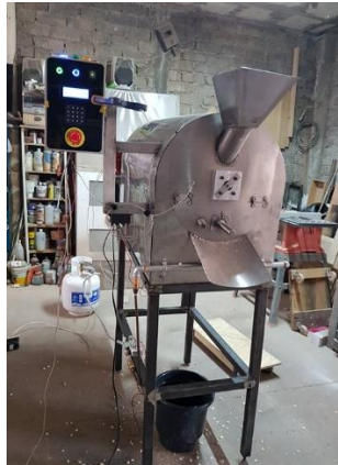
Figura 69. Tostadora con interfaz.
