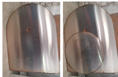
Figura 51. Tapas de la cámara de tostado y de combustión.
