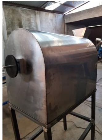
Figura 53. Cámara de combustión y base, vista trasera.
