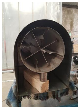
Figura 65. Montaje de cámara de tostado.
