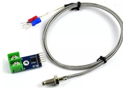
Figura 36. Termocupla tipo K con módulo MAX6675.
