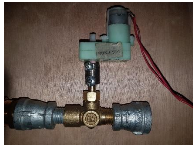
Figura 70. Modificación de válvula.
