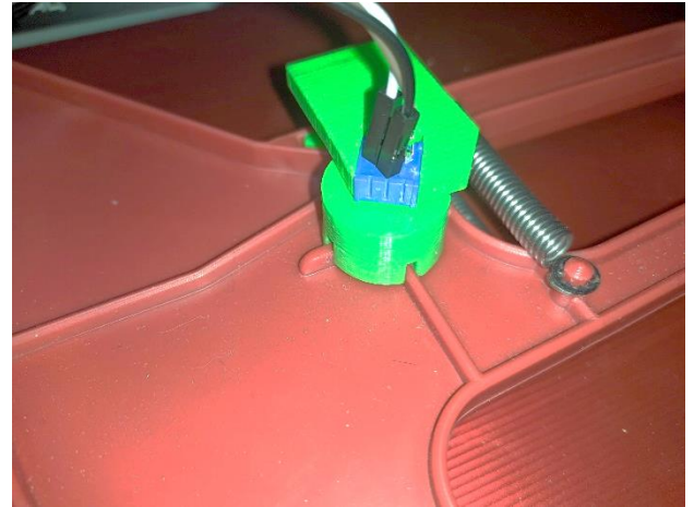
Figura 64 Sistema embebido ( Sensor angular)
