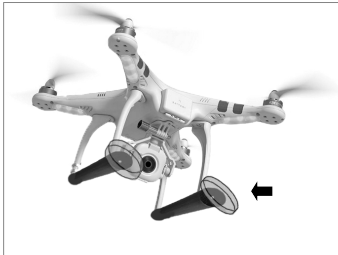
Figura 2. Muestreo de Soplos. Drone phantom 2 con cajas de Petri adaptadas en la parte inferior adheridas a tubos de goma (Flecha).
