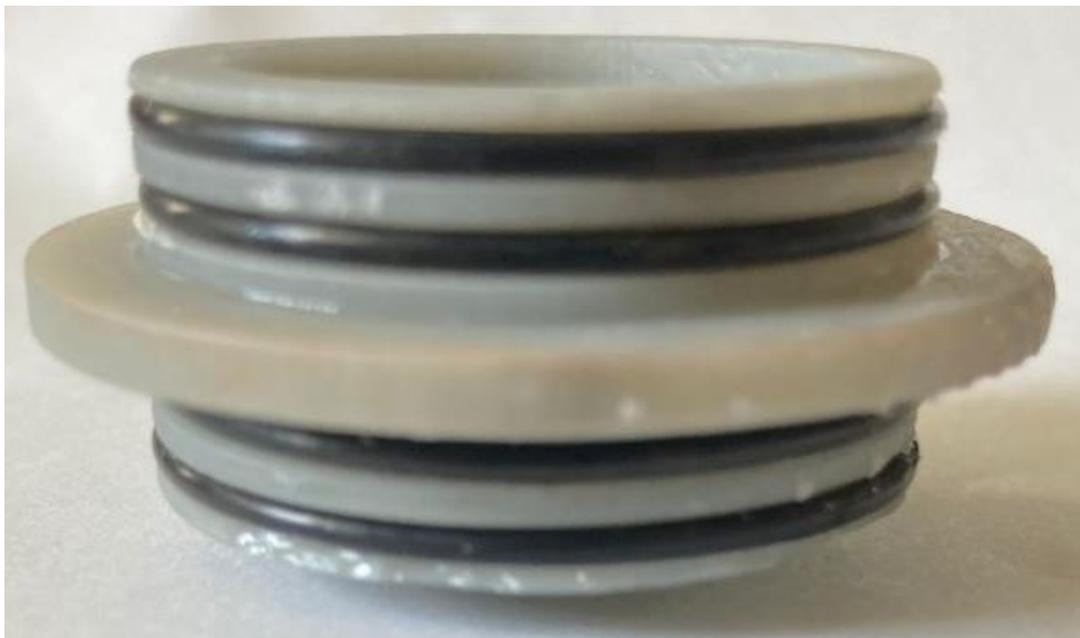
*Figura 12. Vista lateral de la placa de un orificio.*
