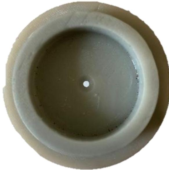
*Figura 11. Vista frontal de la placa de orificio.*
