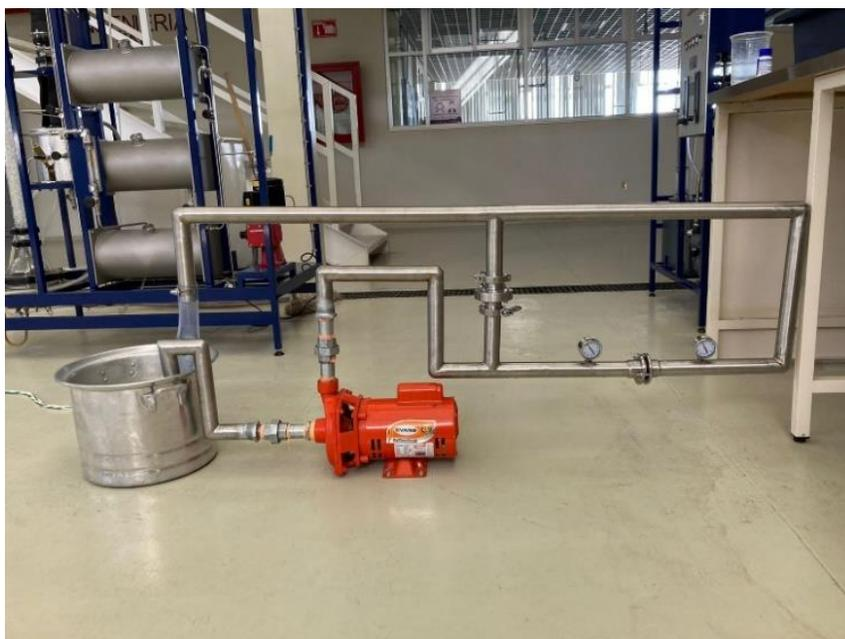
*Figura 10. Segundo prototipo construido para llevar a cabo la cavitación con una bomba de potencia de 1 HP.*
