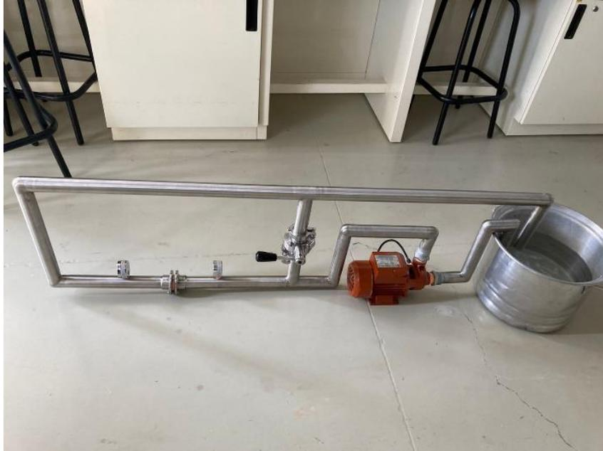
*Figura 9. Primer prototipo para llevar a cabo la cavitación con una bomba de potencia de  $\frac{1}{2}$  HP.*
