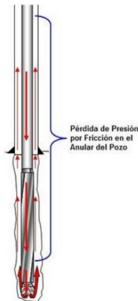
Figura 12. Pérdida de presión por fricción en el espacio anular 4 .
