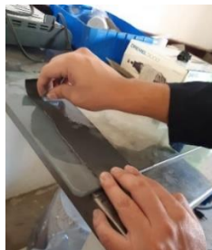
Figura 10. Preparación de probetas metalográficas
