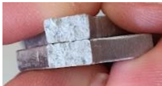
Figura 14. Fractura frágil de probeta reforzada
