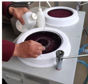
Figura 11. Pulido de probetas metalográficas
