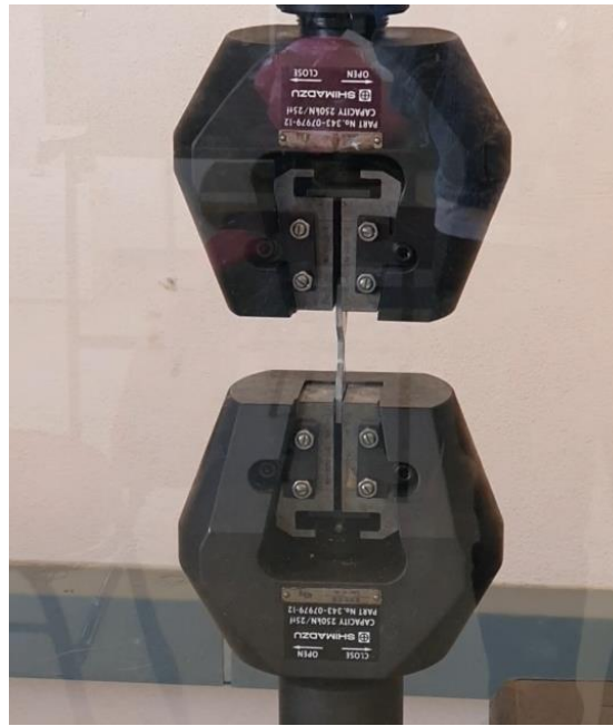
Figura 8. Máquina de ensayos universal para ensayos de tensión
