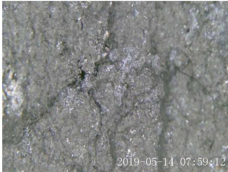
Figura 15. Clúster de nano fibras en probeta B 0.1%
