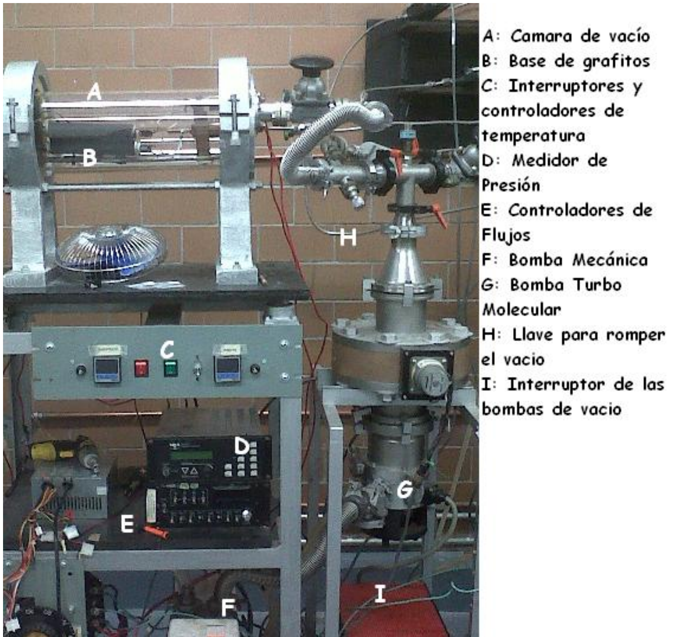
Figura 3.2: Equipo utilizado para el depósito de CdTe y CdCl_2 mediante la técnica de CSV
