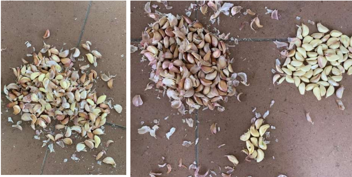
Figura 89. Prueba de 500 gr a una sola pasada. a) Dientes expulsados. b)Dientes clasificados(no pelados, pelados y dañados).
