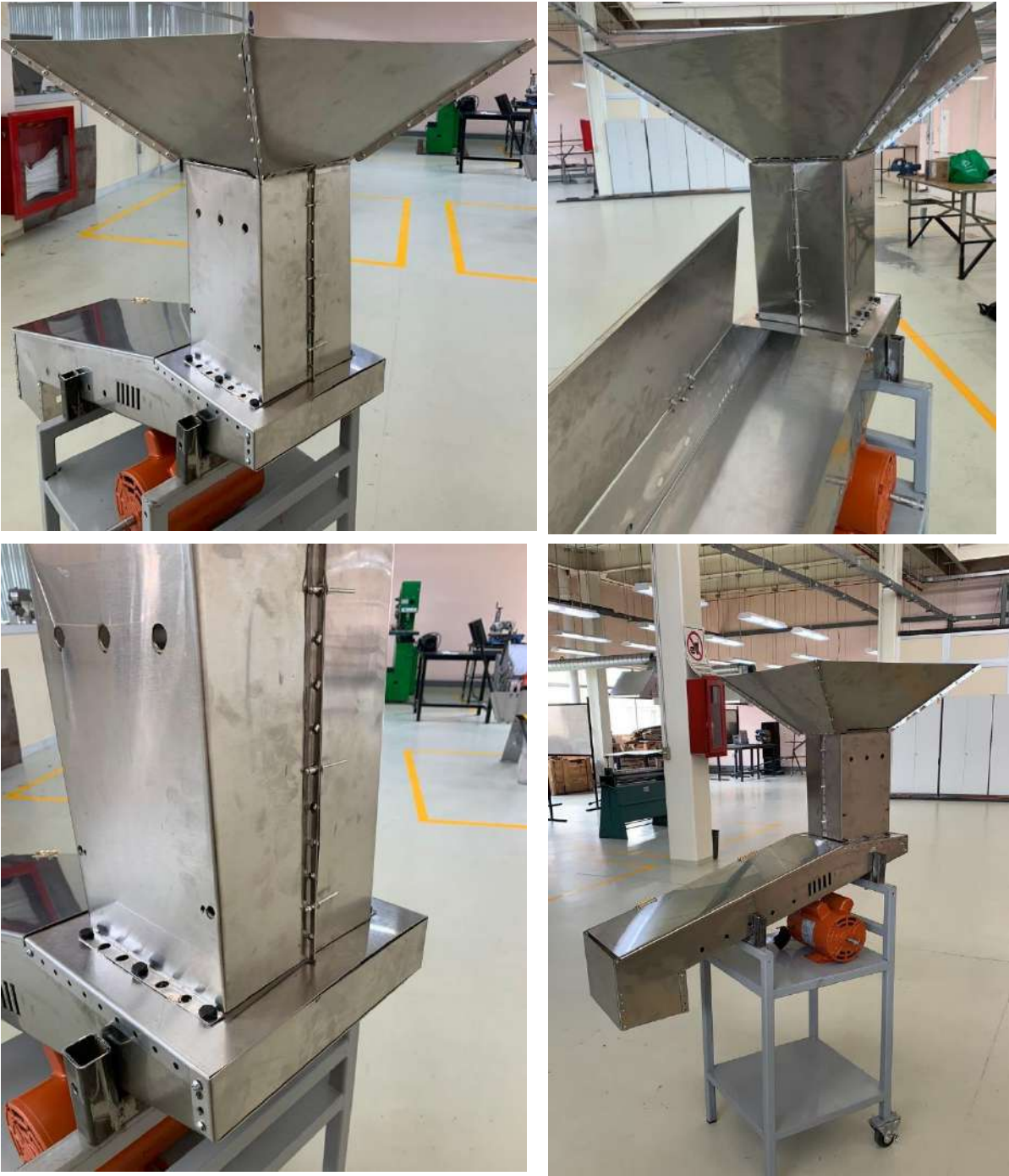
Figura 65. Ensamble de cajón, tolva y ducto.
