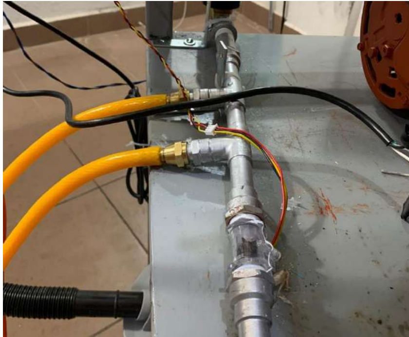
Figura 74. Sensor de flujo montado.
