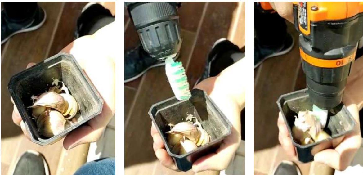
Figura 94. Proceso de prueba experimental con cepillo giratorio.
