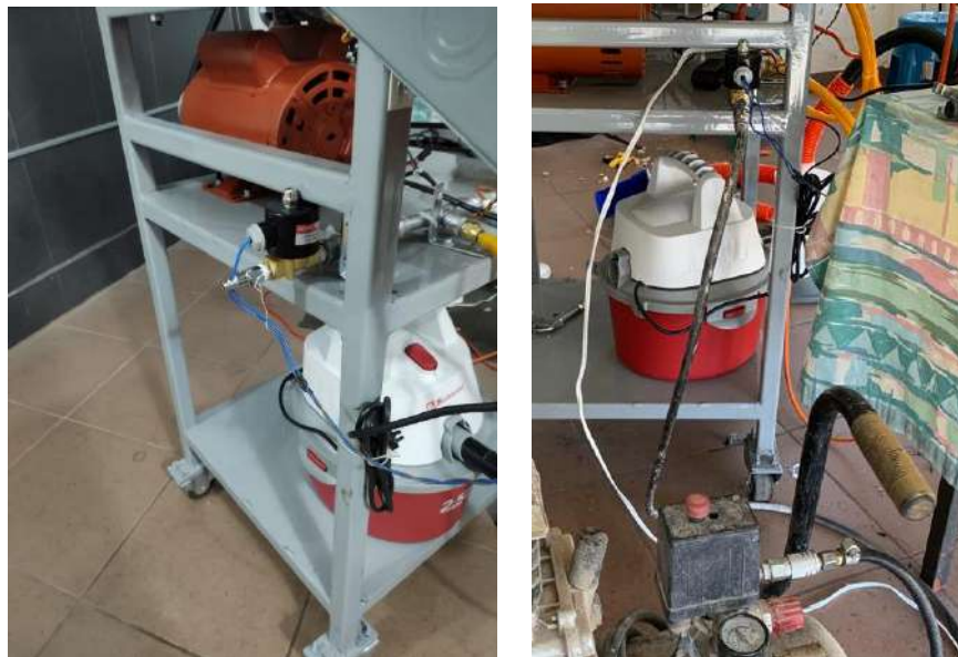
Figura 76. Válvula solenoide conectada al compresor de aire.
