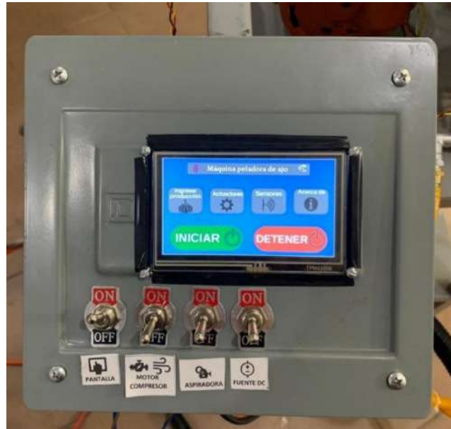
Figura 69. a) Gabinete instalado a 40°. b) Vista frontal del gabinete.
