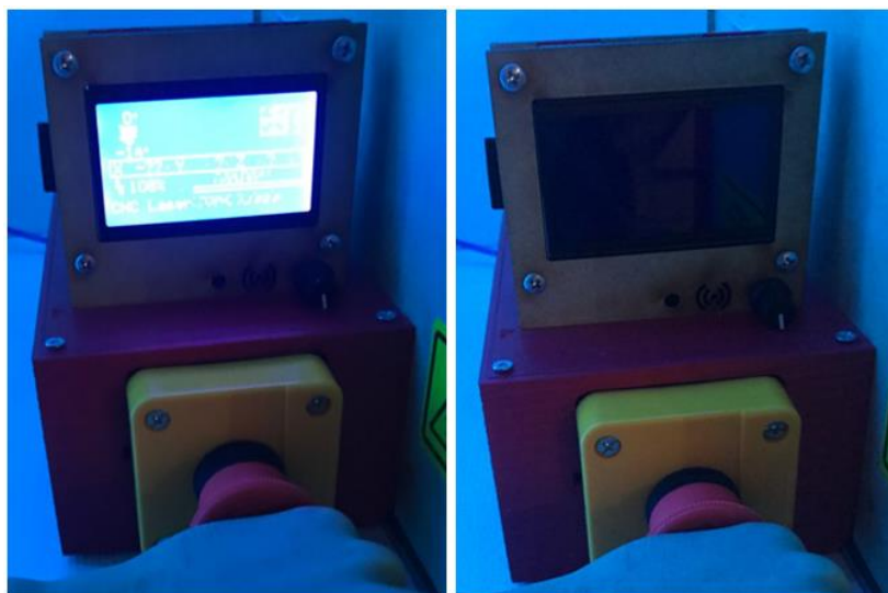
Figura 80. a) (Izq) Paro de emergencia sin presionar. b) (der) Paro de emergencia presionado.
