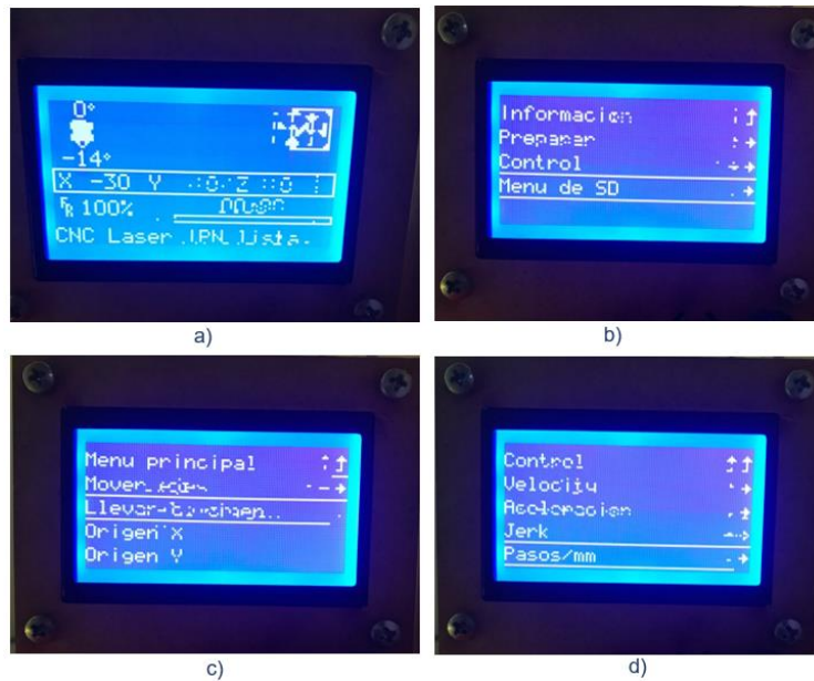
Figura 64. Menú de interfaz. a) Información de inicio, b) Menú principal c) Preparar máquina, d) Control de máquina
