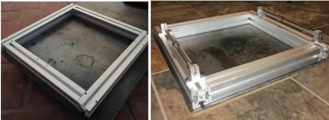
Figura 57. Estructura base y perfiles de aluminio: a) (izquierda) perforados b) con soportes y guías ensamblados
