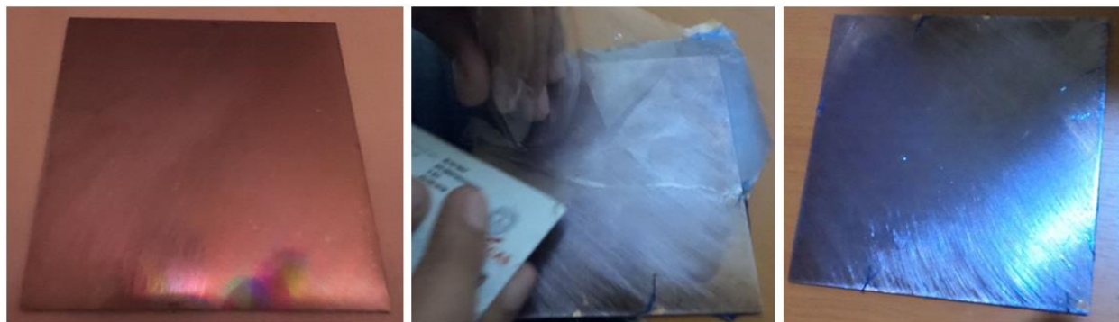
Figura 81. Preparación de la placa de cobre antes del grabado.
