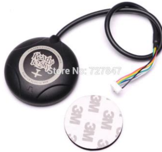
Figura 23. Módulo de la marca Readytosky con el receptor GPS Ublox NEO-M8N [47].
