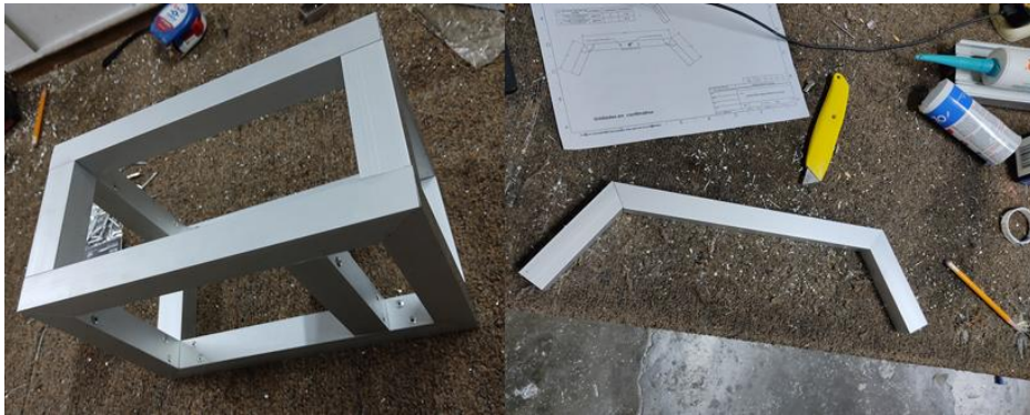
Figura 39. Corte y remachado de las piezas de aluminio.
