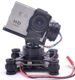
Figura 24. Estabilizador para cámara de 3 ejes de la marca Readytosky [48].
