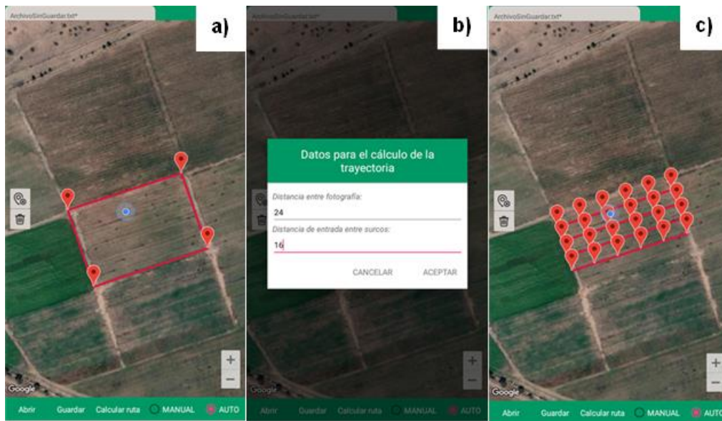
Figura 70. Prueba de interfaz. a) Selección de área, b) Parámetros de trayectoria, c) Generación de trayectoria.
