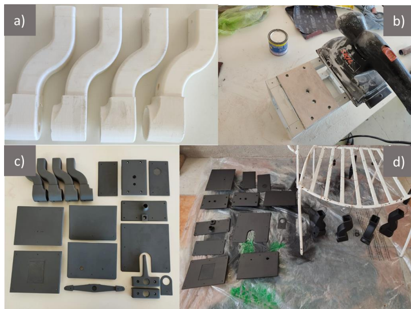
Figura 43. Post-procesado de las piezas. a) Curado, b) Resanado y lijado, c) Fondeado, d) Pintado.
