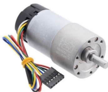
Figura 22. Motorreductor 131:1 37Dx73Lmm con encoder de la marca Pololu [36].
