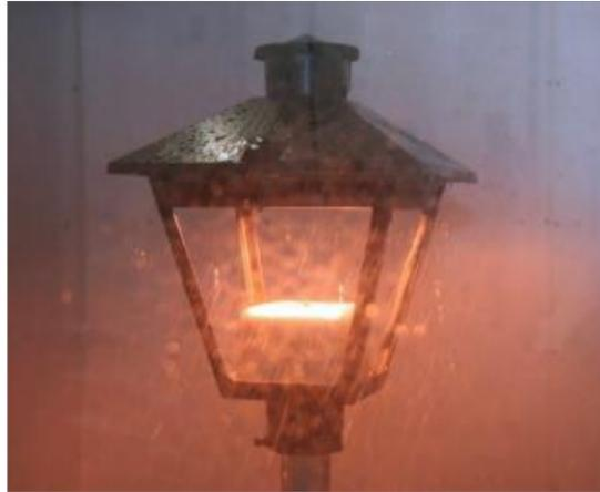
Figura 2.3 Luminario sometido a la prueba de lluvia recuperado de (Holophane,2010, p. 12)
