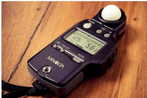
Figura 2.4 fotómetro para realizar pruebas a luminarios (<https://www.xatakafoto.com>)
