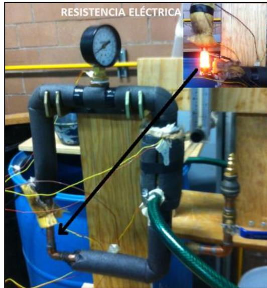
Figura 3.5 Resistencia Eléctrica
