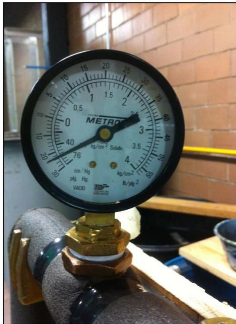
Figura 3.2 Vacío de 56 cmHg generado en el interior del termosifón
