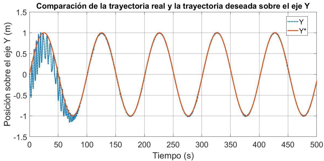
Figura 7.2 Gráfica de los valores de Y^* (trayectoria deseada) y valores de Y (trayectoria real).
