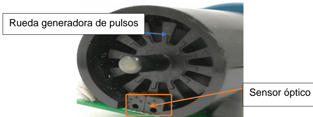
Figura 3.7 Vista del encoder de los motorreductores propuestos [FP].
