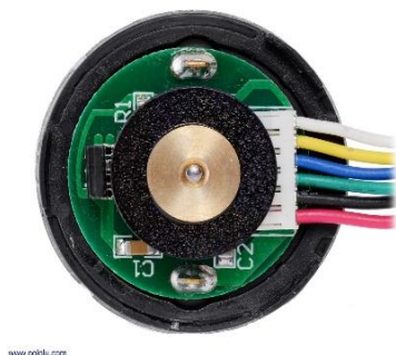
Figura 3.6 Encoder del motorreductorPololu 37Dx70L [20].
