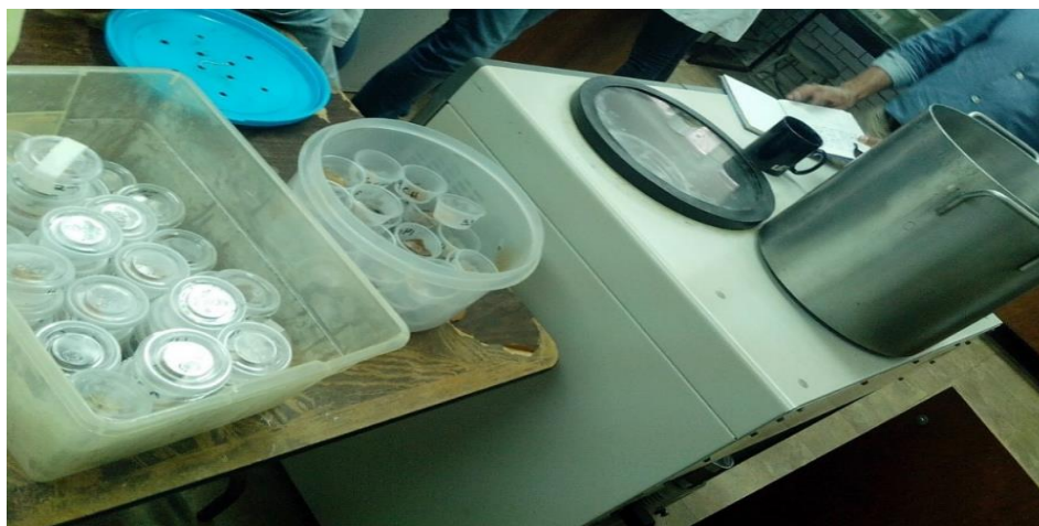
Figura 2. Proceso de secado en frío de muestras en liofilizadora LABCONCO.
